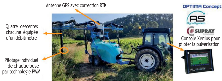
FIG. 1 : Prototype de pulvérisateur développé dans le cadre du projet ABA PIC et basé sur la technologie de contrôle des buses PWM (dispositif baptisé SRP (Smart Regulation Pressure) par Optima Concept)
