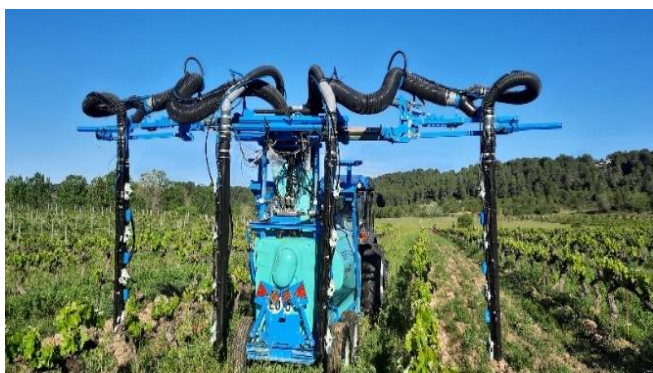
Figure 1 - Pulvérisateur Berthoud Win'Air équipé de la solution de contrôle des buses SRP ( Smart Regulation Pressure ) conçue par OPTIMA Concept® (AgroSystem) - (Crédit UMT ECOTECH (IFV-INRAE)).
